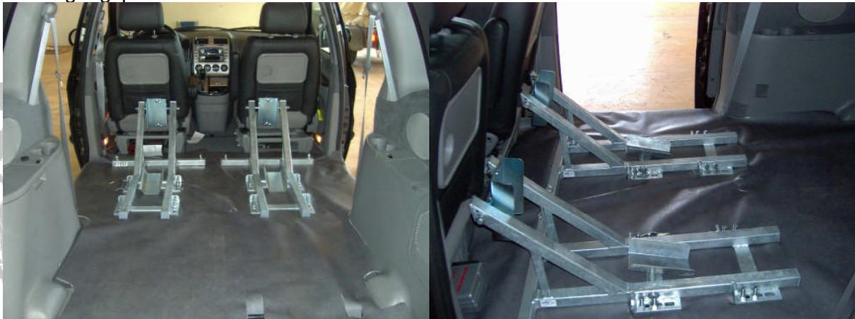
Der EasyLog in einem MB Vaneo in den originalen Sitzschienen eingeklinkt
